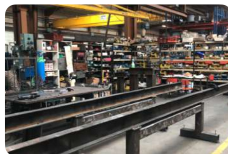
Rework of beams © Opalis (Général Métal Réédition)
