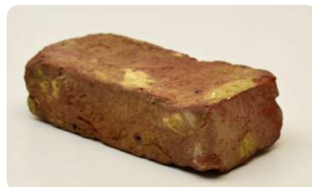
Boomse Klampsteen hand moulded reclaimed brick (BE)
