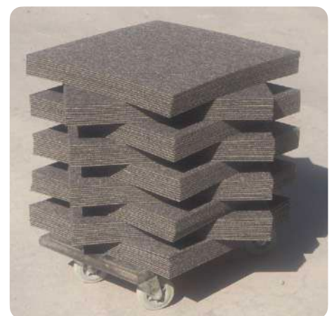
Verplaatsing van tegels met rolwagentjes. Een overhoekse schikking vergemakkelijkt de behandeling.
