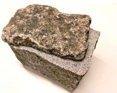
Afzagen van het bovenste deel van de kassei
