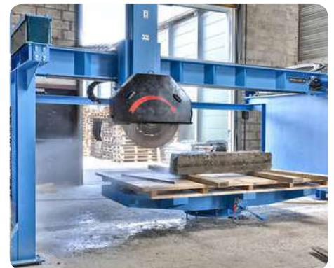
Overlangs verzagen van boordstenen © Steengroeve Bonneuil-sur-Marne
