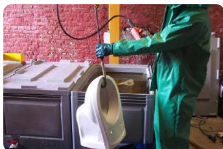
Fase 1. Onderdompeling van het sanitair in een zuurbad
