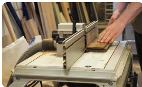
Machinale (opnieuw) aanbrengen van tanden en groeven
