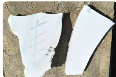
'Poreus' glazuur (links) vs glazuur in goede staat (rechts)
