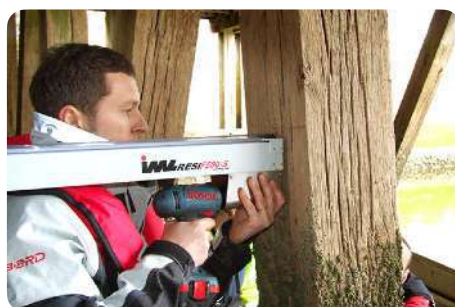
Hardheidstest met een resistograaf © qsb.fr
