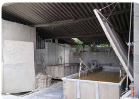
Loogbad voor het decaperen van deuren
