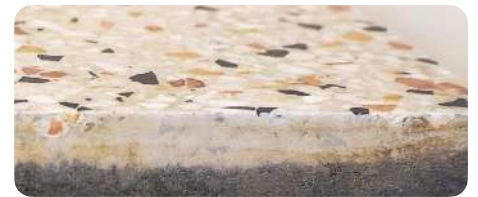
Enkellaagse terrazzo tegel - doorsnede
