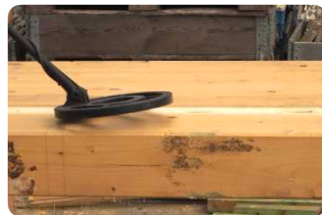
Inspectie met een metaaldetector
