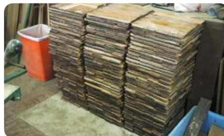
Hergebruik van 50 m 2 parket in visgraatmotief. De planken werden in de dikte doorgezaagd om de oude bitumenlijm te verwijderen. Daarna werden ze bewerkt om in Hongaarse punt te worden geplaatst (gelijmde plaatsing), Boom, België © Atelier Passe Partout
