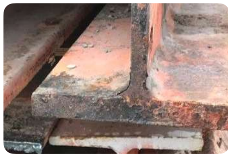
Aantasting van de oorspronkelijke coating © Gebruikte bouwmaterialen Weert
