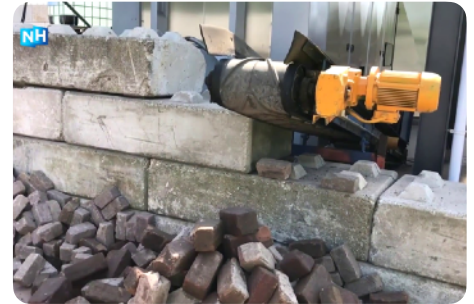
Geautomatiseerd reinigings- en verpakkingsproces van gerecupereerde kleiklinkers. © NH Nieuws, 2018 ( https://www.youtube.com/watch?v=lmeWIMkrwoU )
