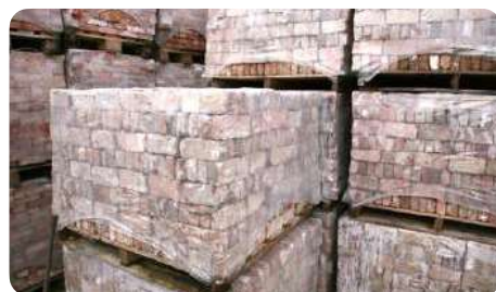
Opslag van gesorteerde en gereinigde bakstenen op pallets, afgedekt met krimpfolie
