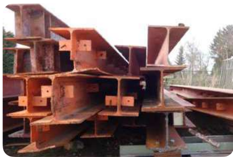
Gerecupereerde balken met gelaste verbindingen © Gebruikte bouwmaterialen Weert
