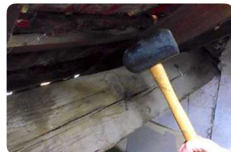
Test met een rubberen hamer © Romane Lavoine
