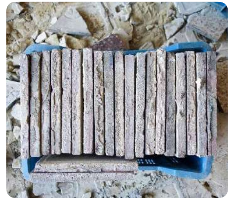
Tegels oorspronkelijk geplaatst in een bastarmortel: weinig mortelresten na demontage.
