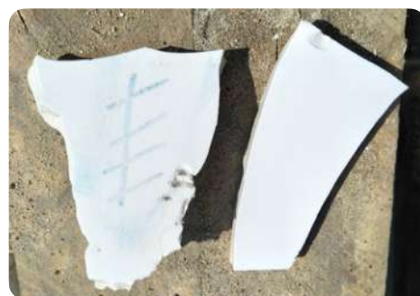
'Poreus' glazuur (links) vs glazuur in goede staat (rechts)
