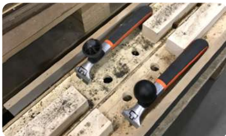
Gereedschap om de tand- en groefverbindingen mee te reinigen
