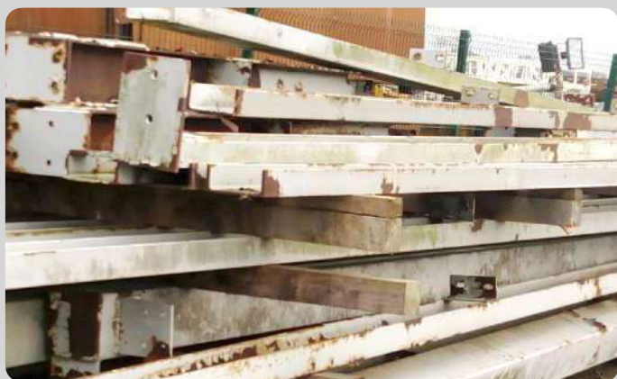
NTS-gebouw (2017), Thirsk (VK). Hergebruik van stalen liggers als draagstructuur © Cleveland Steel and Tubes (CST)
