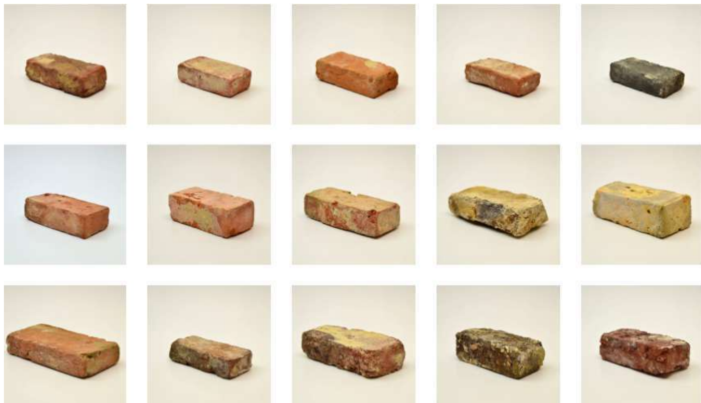
Soorten hergebruikbaksteen op de Belgische markt. Van links naar rechts, van boven naar onder: 1. (Boomse) Klampsteen of handgevormde Klinkaard (rijnvorm). 2. (Boomse) Klampsteen of handgevormde Klinkaard (derdeling). 3. Paepsteen (rijnvorm). 4. Paepsteen (derdeling). 5. Blauwe Paepsteen (derdeling). 6. Beerse steen of machinale Klinkaard (rijnvorm). 7. Beerse steen of machinale Klinkaard (Beerse 65). 8. Beerse steen of machinale Klinkaard (waalformaat). 9. Handgevormde Poldersteen (moef) of Brugse moef/Poldersteen. 10. Damse Poldersteen (moef) of Damse (abdij)moef, Kuststeen. 11. Spaanse moef. 12. Brusselse Klampsteen. 13. Scheldesteen. 14. Scheldesteen (dik). 15. Veldovesteen.
