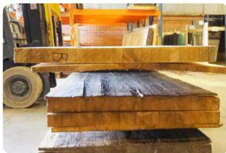
Overlangs (in de lengte) gezaagd GGH
