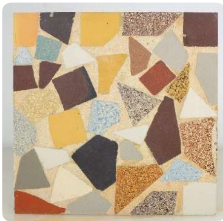
Terrazzo tegel met scherven van andere tegels als granulaat
