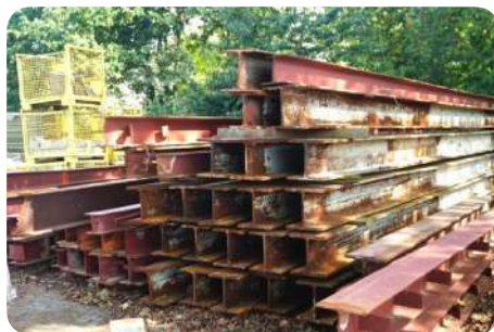
Opslag van stalen hergebruikliggers, met roestwerende beschermingslaag (rood) en zonder beschermingslaag (roest en witte verf) © Gebruikte bouwmaterialen Weert
