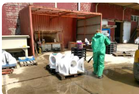
Fase 2. Afspoelen met een hogedrukreiniger
