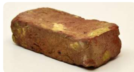
Gerecupereerde handvormsteen van het type Boomse Klampsteen (België)
