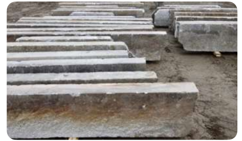
Oude boordstenen in natuursteen (19e - 20e eeuw) - de bovenzijde is gezaagd, de andere zijden zijn manueel gehouwen. De stenen hebben een vrij regelmatige vorm. © stonecurators.com
