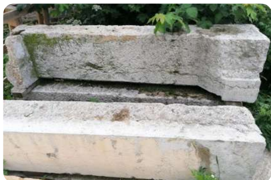
Inspiratie . Platte muurkappen gezaagd uit gerecupereerde blokken Villebois-steen © Antic-Mat
