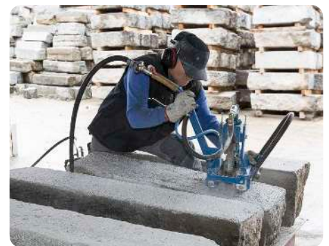
Gehamerde afwerking van boordstenen © Steengroeve Bonneuil-sur-Marne
