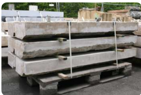
Bordures de réemploi en calcaire blanc
