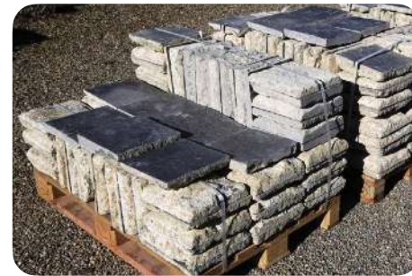
Stockage sur palette sanglée belle face contre belle face © De Opkamer
