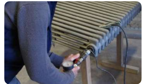
Test de mise sous pression © Decapfonte
