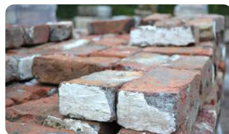
Présence de traces de peinture et légers restes de mortier
