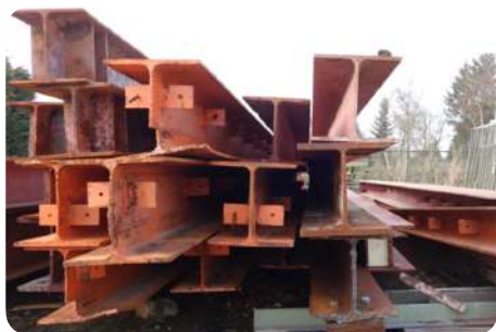
Poutrelles récupérées avec des raccords soudés © Gebruikte bouwmaterialen Weert
