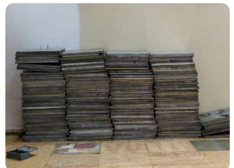
Dalles déformées ou non conformes, non récupérées.
