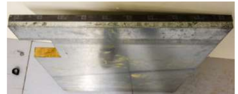
Dalle incomplète, non revêtue, à base de bois aggloméré, encapsulée dans une tôle d'acier galvanisé. La moitié du chant est muni d'une bande de PVC autoextinguible.
