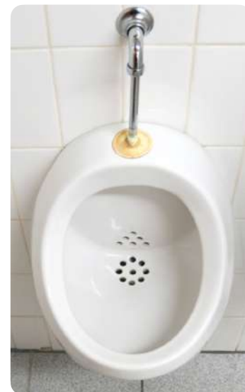
Urinoir suspendu à action siphonique, avec bride, alimentation apparente par le dessus et bonde intégrée
