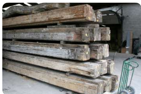
Poutres anciennes en chêne
