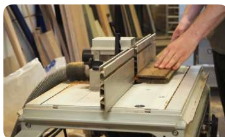
Réusinage des rainures et languettes
