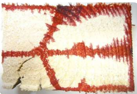
Coloration rouge révélant une absence de traitement. © expert-bois.fr
