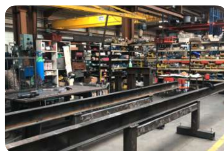
Réusinage des poutrelles © Opalis (Général Métal Réédition)
