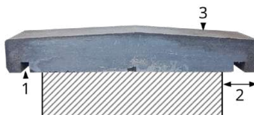
Figure 1. Profil d'un couvre-mur en pierre naturelle standardisé
