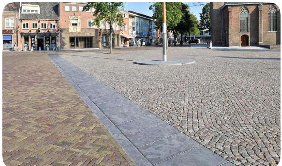
Aménagement d'une place en pavé de terre cuite de réemploi, Schijndel (NL), 2020 © Stone Base
