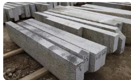
Bordure en pierre naturelle ultérieure au début du 20 ème siècle - fabrication à l'aide d'outils mécaniques - aspect uniforme et précis. © stonecurators.com
