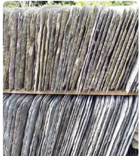
Stockage d'ardoises de réemploi © hastingswhite.co.uk
