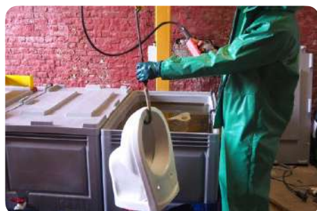
Phase 1. Trempage des éléments dans un bain d'acide spécifique
