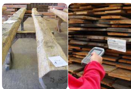
Etiquetage des poutres, classement visuel ou classement par machine © yr-architecture
