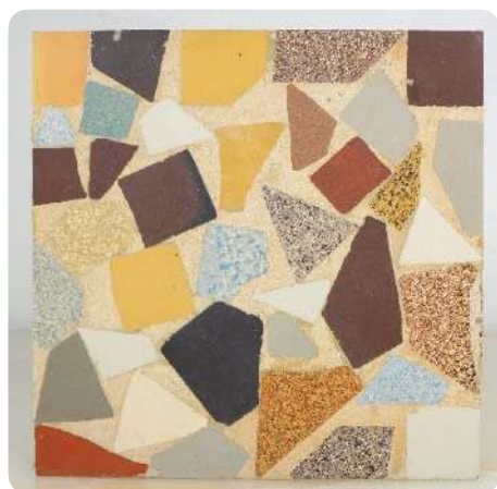
Carreau de mosaïque de marbre dont l'agrégat est constitué de chutes de carreaux de grès cérame.
