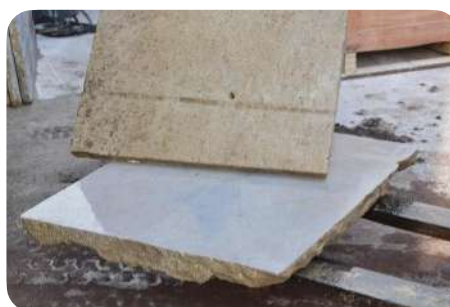
Sciage des dalles dans l'épaisseur, partie inférieure plus épaisse et irrégulière
