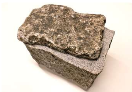
Sciage de la partie supérieure
