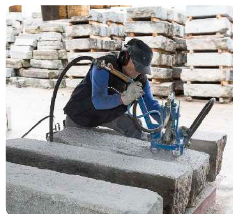
Finition des bordures par bouchardage © Carrière de Bonneuil-sur-Marne
