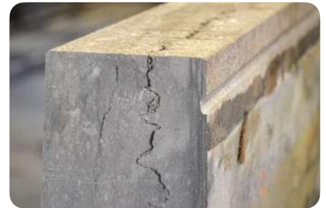
Exemple de joints stylolithiques
