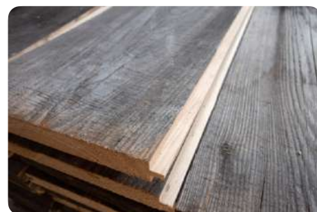
Usinage de planches pour obtenir un profil d'assemblage rainure/languette
