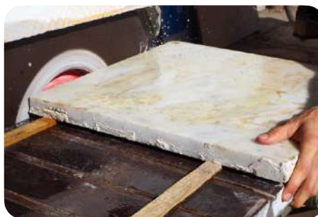
Retrait des résidus de mortier sur la tranche au moyen d'un lapidaire
