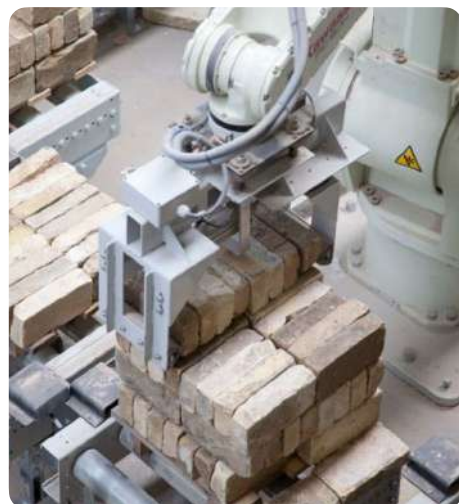
Tri et packaging mécanisé de briques de réemploi © Gamle Mursten (DK)
