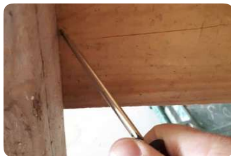
Test au « tournevis » © qualite.bzh
