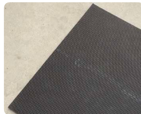
Envers d'une dalle de moquette posée sans colle.
