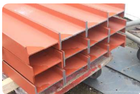
Poutrelles sciées © Opalis (Wolter Bouwmaterialen)
