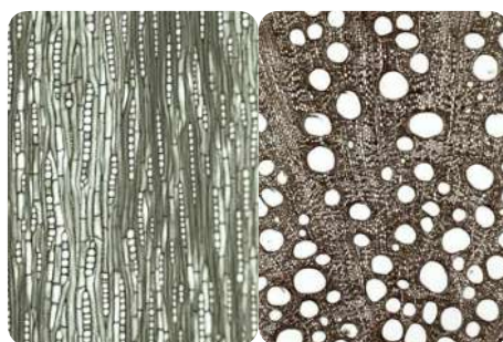
Analyse en laboratoire - technique de microscopie optique, chêne ( Quercus Petraea ) - section tangentielle (à gauche) et microdécoupe transversale (à droite) © woodanatomy.ch
