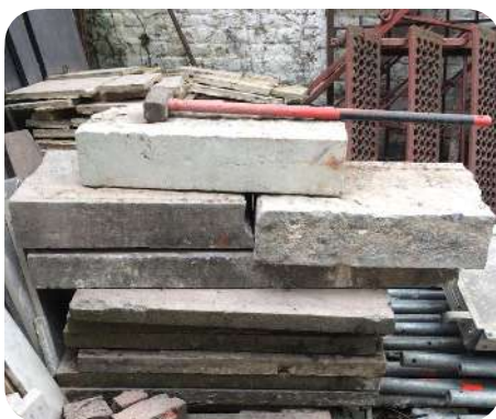
Couvre-murs extérieurs en pierre bleue réutilisés pour la réalisation d'une terrasse, Bruxelles (BE) © VLA architecture https://www.guidibatimentdurable.brussels/fr/reemploi.html?IDC=10994
