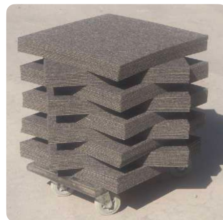
Déplacement de dalles au moyen de chariots. La disposition en quinconce facilite la manutention.
