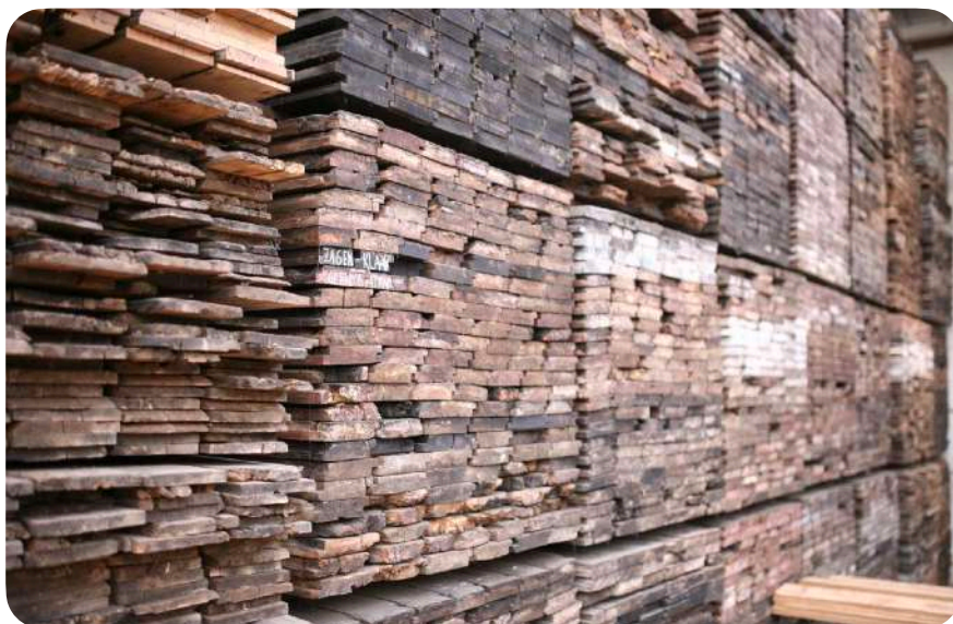
Lames de plancher en bois massif récupérées
