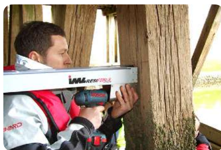
Test de dureté à l'aide d'un résistographe © qsb.fr
