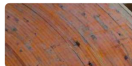
Fissures de délamination © SGI
