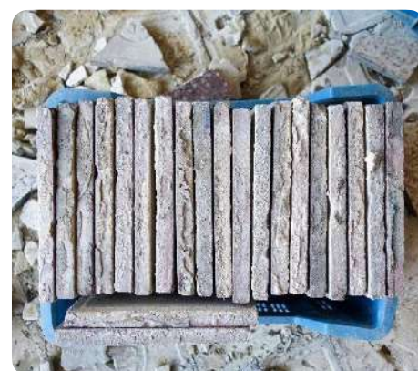
Résidu de mortier sur les carreaux déposés (mortier bâtard)
