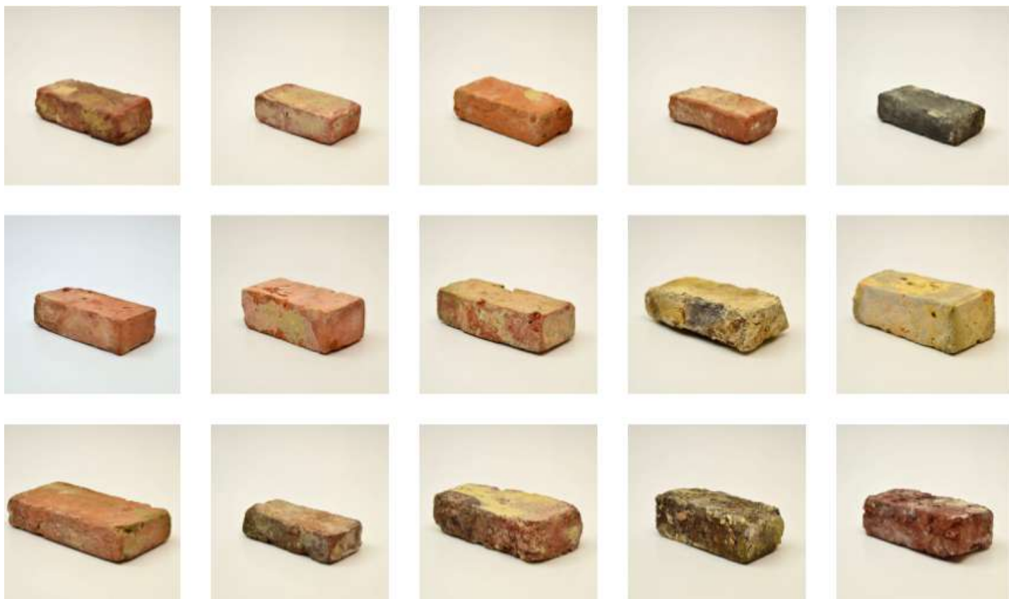
Variétés de briques de réemploi sur le marché belge. De g. À d., en partant du haut : 1. (Boomse) Klampsteen ou Klinkaard faite à la main (rijnvorm). 2. (Boomse) Klampsteen ou Klinkaard faite à la main (derdeling). 3. Papesteen (rijnvorm). 4. Papesteen (derdeling). 5. Papesteen bleue (derdeling). 6. Beerse steen ou machinale Klinkaard (rijnvorm). 7. Beerse steen ou machinale Klinkaard (Beerse 65). 8. Beerse steen ou machinale Klinkaard (waalformaar). 9. Poldersteen faite à la main (moef) ou Brugse moef/poldersteen. 10. Damse Poldersteen (moef) ou Damse (abdij)moef, Kuststeen. 11. Spaanse moef. 12. Brusselse Klampsteen. 13. Scheldesteen. 14. Scheldesteen (dik). 15. Veldovensteen.
