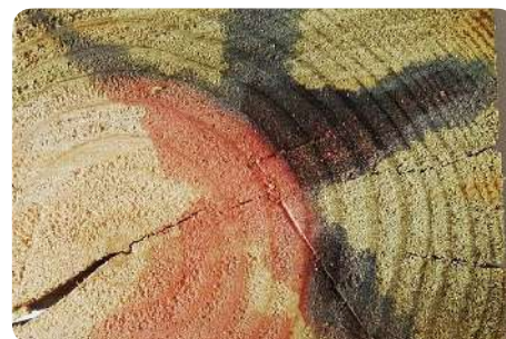
Coloration bleutée révélant la présence d'un traitement (limité à l'aubier). © expert-bois.fr
