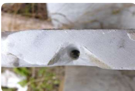
Trou d'ergot élargi lors de la dépose
