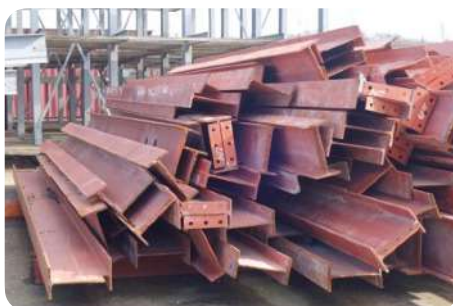
Poutrelles IPE de réemploi, avec traitement de protection anticorrosion © Opalis (Omgekeerd Bouwen)
