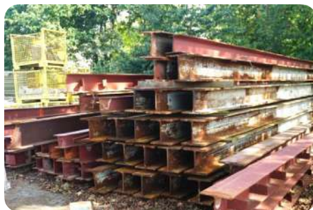
Stockage de poutrelles de réemploi en acier, avec revêtement de protection anticorrosion (en rouge) et sans revêtement (rouille et peinture blanche) © Gebruikte bouwmaterialen Weert
