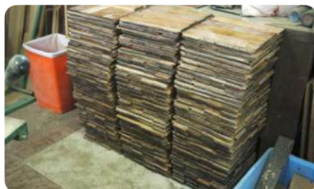
Réemploi de 50 m 2 de parquet à bâton rompu. Les lames ont été sciées dans l'épaisseur afin d'éliminer l'ancienne colle au bitume. Elles ont ensuite été réusinées afin d'être remise en œuvre (pose collée) sous un motif en point de Hongrie, Boom (BE) © Atelier Passe Partout
