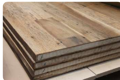
Placage de bois de grange sur panneau multiplis. © Rotor © Atmosphère Bois
