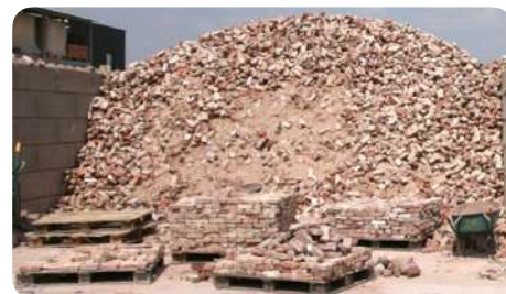
Stockage des briques démontées avant tri et nettoyage, chez un revendeur professionnel
