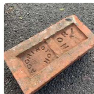
Brique de réemploi moulée mécaniquement de type Accrington (UK)
