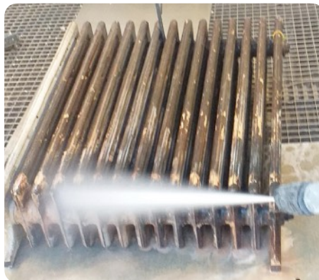
Nettoyage à haute pression
