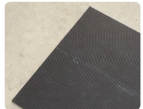
Rug van een niet-verlijmdes tapijttegel.
