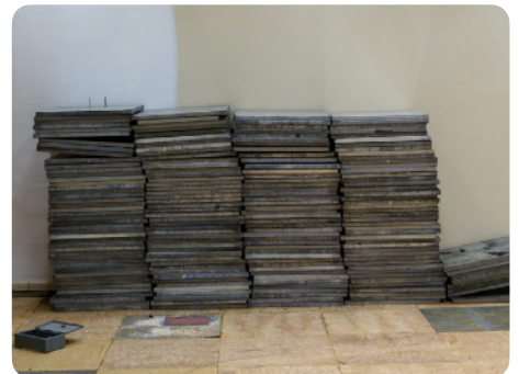
Vervormde of niet-conforme tegels, niet geschikt voor hergebruik.
