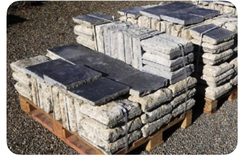
Stockage sur palette sanglée belle face contre belle face © De Opkamer
