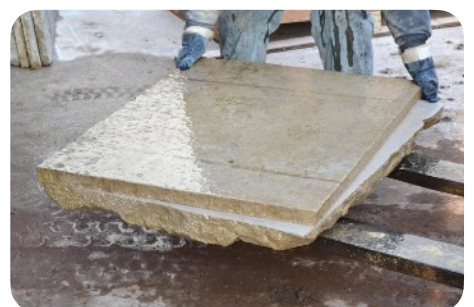
Sciage des dalles dans l'épaisseur, partie supérieure lisse et régulière
