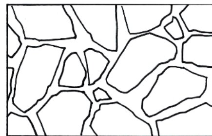
Opus incertum : format permettant de travailler à partir de fragments quelconque de dalles cassées
