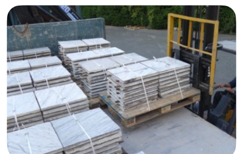
Transport et conditionnement des dalles
