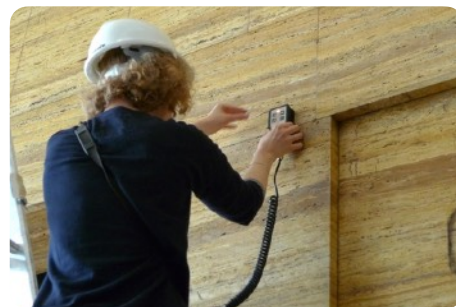
Recherche des éléments métalliques d'ancrage d'un parement en pierre naturelle à l'aide d'un pachomètre. © CSTC
