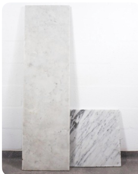
Dalle récupérée en marbre de Carrare
