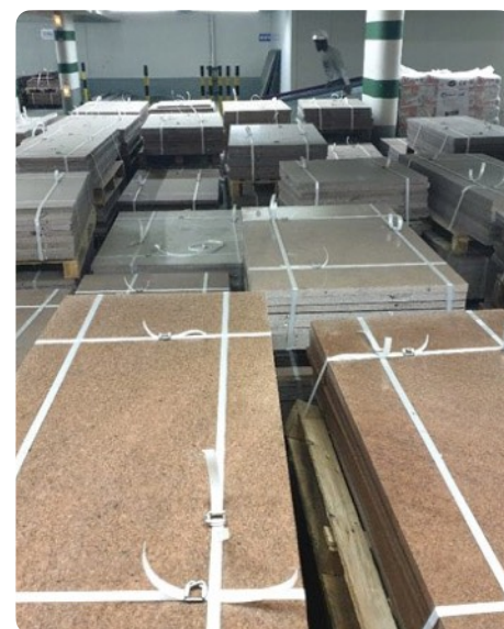
Recuperatie van 5.300 m 2 natuursteenplaten van rood graniet afkomstig van de gevels van de Tour Cèdre in La Défense, Parijs (FR). © Incomex http://pierre-reemploi.com/offre/granit-rouge-de-facade-nr01/
